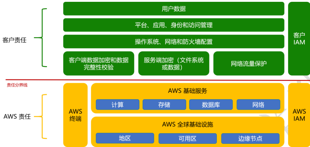
图 5 AWS 基础设施服务责任共担模型
