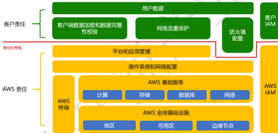
图 6 AWS 容器服务责任共担模型
